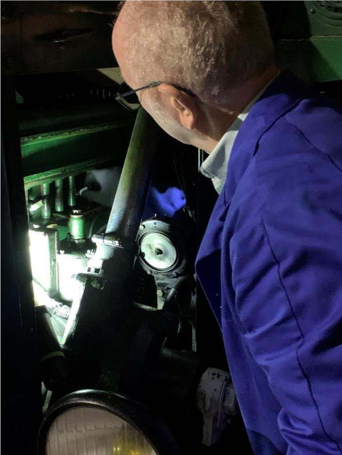
Pascal s'occupe de l'allumage et pour faciliter il va chauffer la bougie avec un décapeur thermique.
